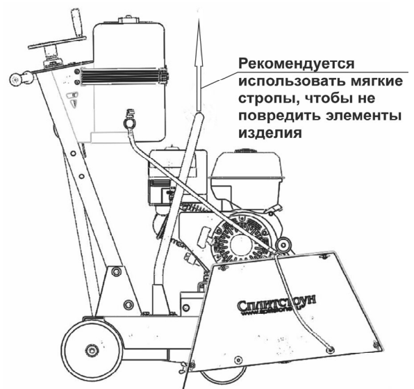
Рисунок 14 – Схема строповки резчика при погрузке/разгрузке
