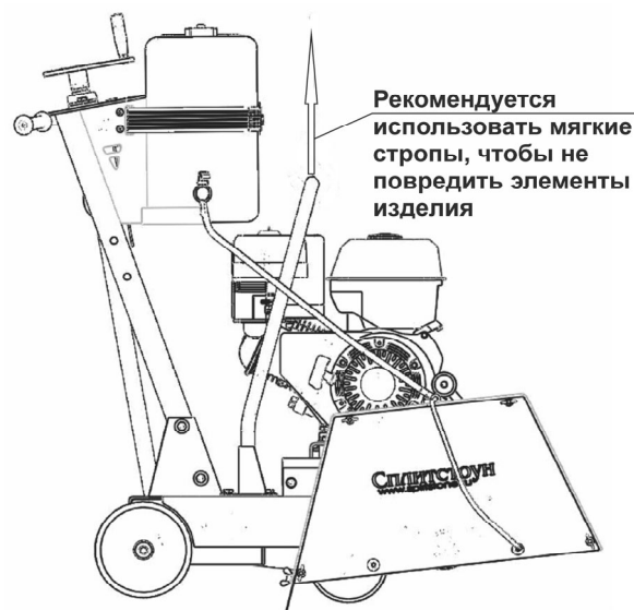
Рисунок 14 – Схема строповки резчика при погрузке/разгрузке
