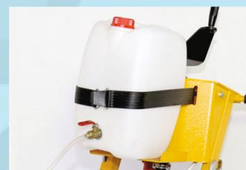
**Система охлаждения инструмента** используется при мокрой резке. 20-литровый бак можно легко снять и заправить водой на расстоянии от места проведения работ. Детали для системы охлаждения при необходимости можно найти в обычном магазине.
