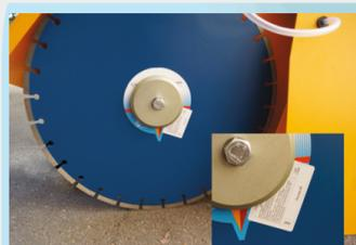
14 серия пополнилась новой моделью СПЛИТСТОУН CS-1413 с высокой производительностью и глубиной реза до 190 мм, которую обеспечивает диск диаметром 500 мм.
