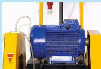
**Автомат защиты электродвигателя** служит для его запуска и останова (в т.ч. при аварийной ситуации), а также предназначен для защиты электродвигателя от короткого замыкания и перегрева обмотки. В этом случае происходит автоматическое отключение и останов электродвигателя.
