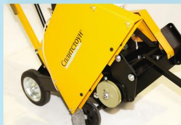
**Быстрая замена ремней** производится путём ослабления/натяжения всего двух болтов. Получить доступ к ремням легко - достаточно снять ограждение клиноременной передачи.
