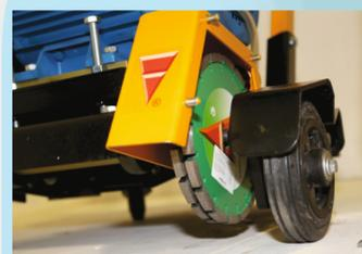
На разделщицах трещин предусмотрена установка как одного, так и двух алмазных дисков, позволяющих получать в дорожном полотне профильный шов размерами до 70 x 10/23 мм за один проход.
