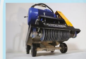
Рабочий инструмент много-дискового резчика швов - до 25 алмазных дисков диаметром 150 мм. Они подбираются в зависимости от требуемой ширины обрабатываемого участка.
