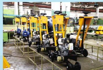
**Универсальная рама** позволяет устанавливать на одно шасси машины как бензиновые так и электродвигатели, предоставляя потребителю больше возможностей при эксплуатации резчиков, делая их более универсальными и ремонтпригодными.
