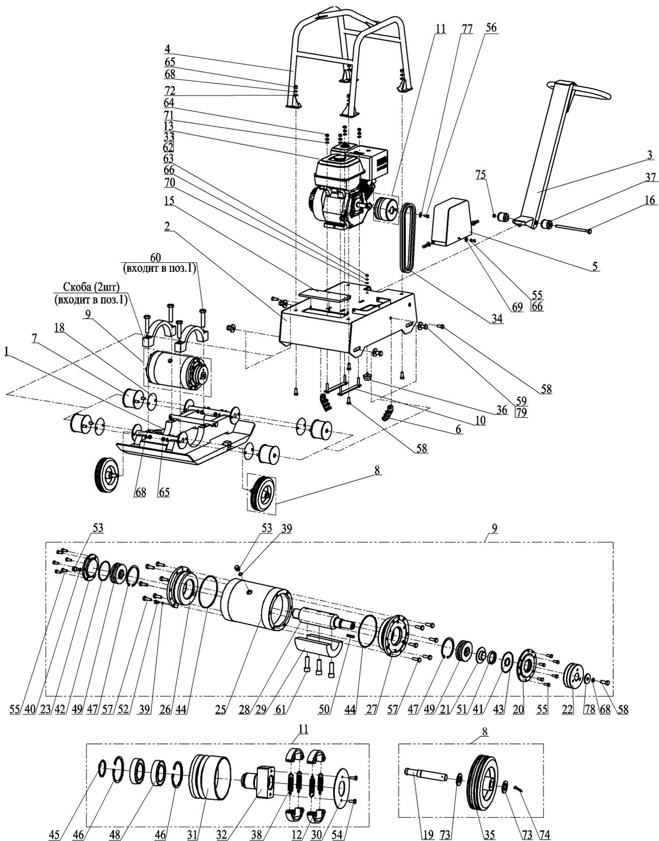
Рисунок 9 – Компоновка виброплиты
