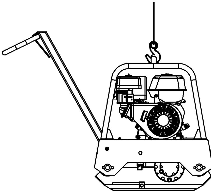
Рисунок 8 – Схема строповки виброплиты при погрузке/разгрузке
