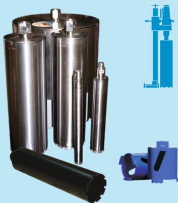
**Свёрла трубчатые** Ø12-400 мм, коронки и сегменты. Для сверления сквозных и глухих отверстий в кирпичных, бетонных и железобетонных конструкциях при прокладке сантехнических, газовых и иных магистралей, для устройства подрозетников, сверления отверстий в природном камне.
