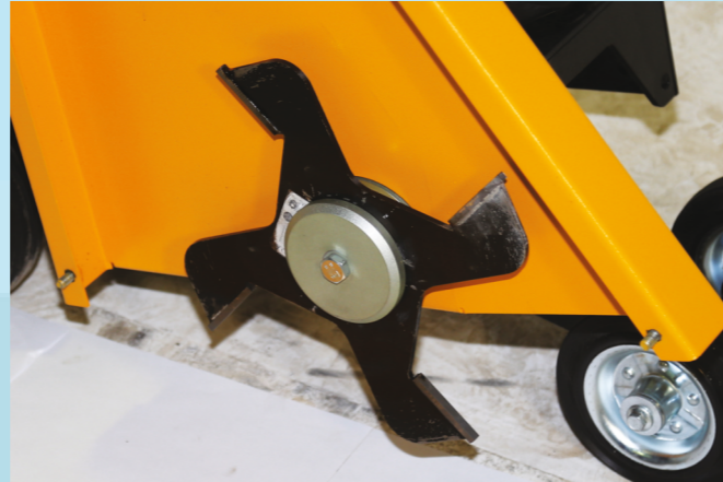
Обратное вращение инструмента способствует эффективному удалению шлама.
