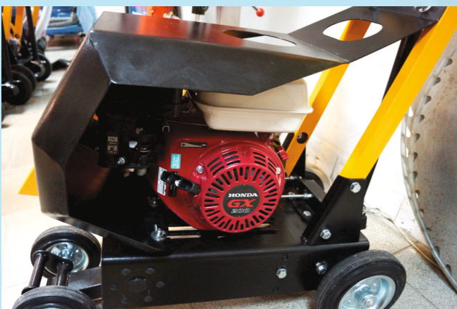
Защитный кожух надёжно предохраняет двигатель от шлама.
